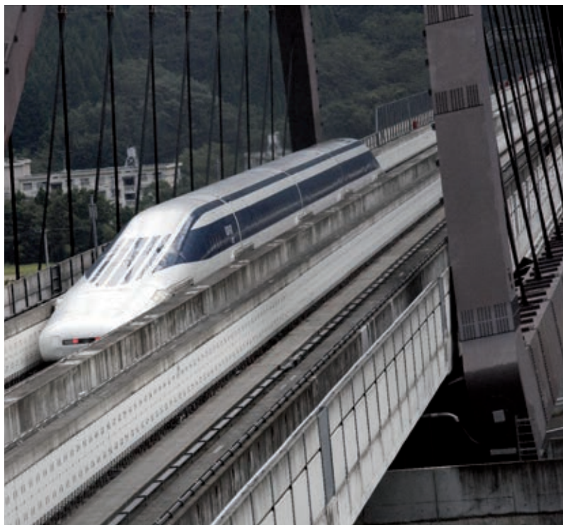
Tren superconductor Maglev, que funciona por medio de imanes, Yamanashi, Japón.
